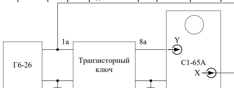
Рис. 10. Схема для исследования передаточной характеристики
