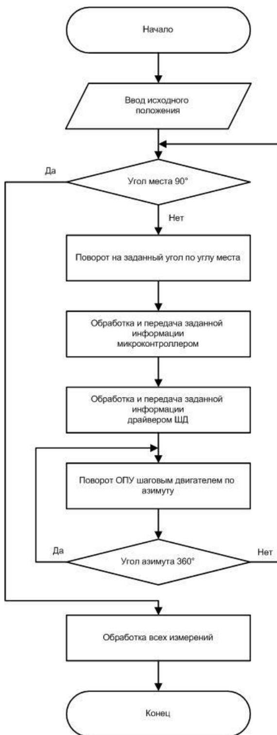
Рисунок 10 – Структурная схема алгоритма работы модуля управления шаговыми двигателями
