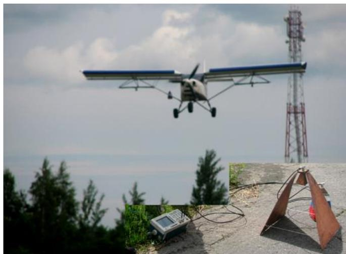
Рисунок 2 – Измерение ДН антенн «облётным методом»
