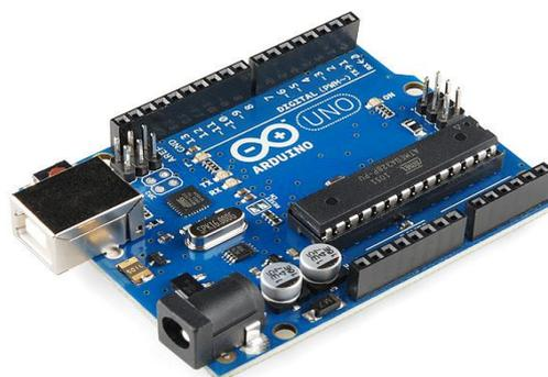
Рисунок 5 – Микроконтроллер Arduino Uno
