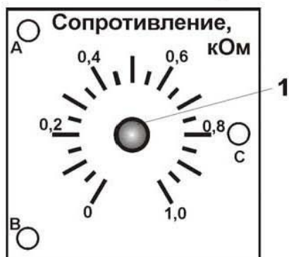
Рис. 18-А. Миниблок «Рео́стат»: 1 – ручка изменения сопротивления АС
