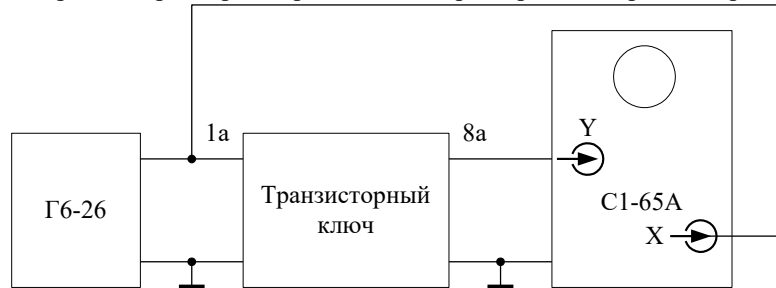
Рис. 10. Схема для исследования передаточной характеристики
