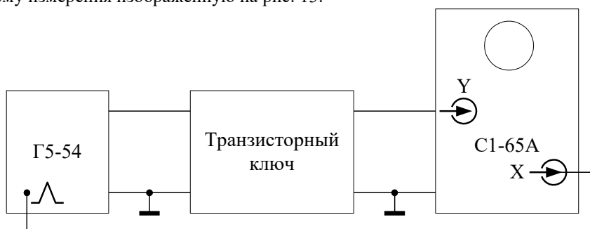
Рис. 13. Схема для исследования влияния ускоряющих емкостей на работу транзисторного ключа
