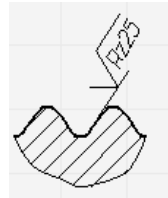
Рисунок 13 – Обозначение шероховатости профиля резьбы
