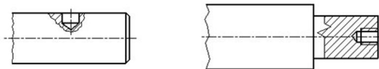
Рисунок 9 – Пример изображения местных разрезов на валах
