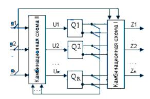
Комбинационная схема, строится на логических элементах, образующих функционально полную систему, а память — на элементарных автоматах, обладающих полной системой переходов и выходов.
