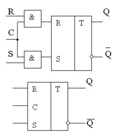
**Вторая техническая особенность** конечного автомата связана с возможностью возникновения неустойчивых состояний и так называемых «гонок» в автомате. Понятие устойчивости заключается в следующем. Пусть в графе автомата мы имеем такой участок:
