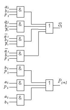
Полученную схему можно упростить, если рассматривать  $S_i$  как функцию 4-х переменных  $S_i = S_i(a_i, e_i, P_i, P_{i+1})$ .
