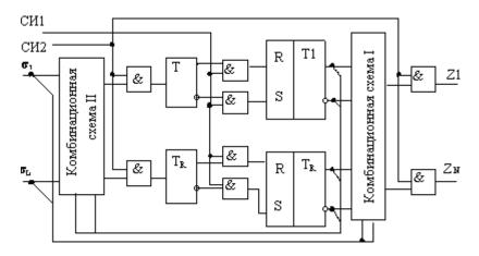
Здесь под действием синхронизирующего сигнала  $CU_1$  формируются выходные сигналы  $\mathbf{Z}_l(t)$  и переключаются триггера первого ряда. Под действием  $CU_2$  состояния триггеров первого ряда переписываются в соответствующие триггера второго ряда. Поскольку  $CU_2$  сдвинуты относительно  $CU_1$ , а сигнал обратной связи о состоянии автомата снимается с триггеров второго ряда, то в момент поступления входного сигнала, то есть в  $CU_1$ , состояние автомата не изменяется и продолжает
