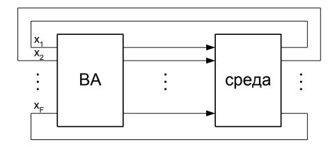
Входные сигналы условно можно разделить на поощрения («нештрафы») и наказания («штрафы»). При этом в зависимости от выходного сигнала на вход подается поощрение или штраф. Если в зависимости от этих сигналов менять вероятности перехода автомата из одного состояния в другое, то оказывается, что с течением времени автомат
