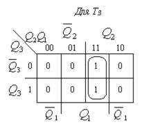
Из диаграмм получаем следующие выражения для сигналов возбуждения триггеров  $T_1=\alpha$ ;  $T_2=Q_1\alpha$ ;  $T_3=Q_1Q_2\alpha$ . Если бы мы синтезировали *п*-разрядный счетчик, то получили бы следующие выражения для сигналов возбуждения триггеров:
