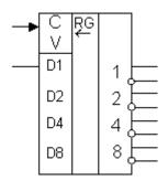
Для указания направления сдвига используется стрелка:  $\rightarrow$  сдвиг в сторону старших разрядов,  $\leftarrow$  сдвиг в сторону младших разрядов.
