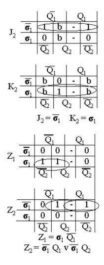
Обычно полученную систему ПФ минимизируют совместно. Однако совместная минимизация всех ПФ представляет собой достаточно трудоемкую и длительную операцию, применимую, в общем случае, при использовании машины. В результате минимизации мы получим следующую схему конечного автомата:
