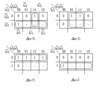
Из диаграмм Вейча получаем следующие выражения для трех функций возбуждения и функции выходов:  $T_{\mathcal{S}} = \alpha \; (Q_{\mathcal{S}} \cup Q_{\mathcal{I}} Q_{\mathcal{S}}); \; T_{\mathcal{S}} = Q_{\mathcal{I}} \alpha; \; T_{\mathcal{I}} = \alpha \; \overline{Q}_{\mathcal{S}}; \; Z = \alpha Q_{\mathcal{S}}$
