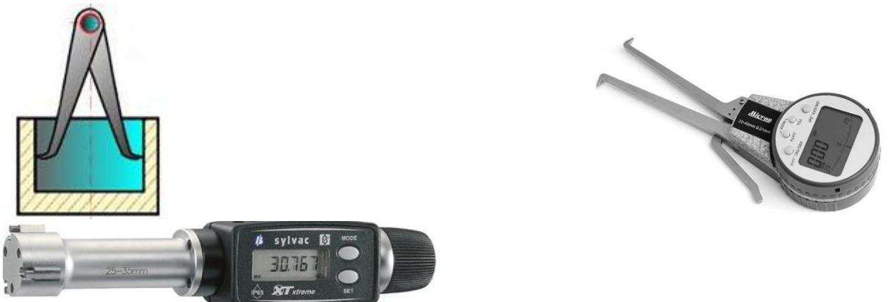
Рисунок 4 – Нутrometer
