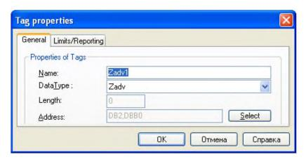
Дозаторы предназначены для набора определенного количества материалов. В проекте Step 7 был создан экземплярный блок данных DB\_Dozat. В проекте WinCC создайте структурный тег Dozator совместимый с этим блоком данных.
