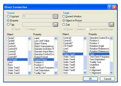
Реализуйте передачу значения свойства текстового поля тегу процесса. В этом случае в правой части окна Direct Connection следует выбрать тег процесса.
