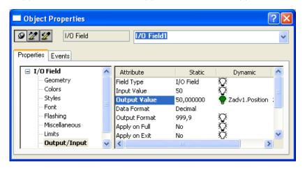
Определите динамику свойства Display для дискретных датчиков задвижки и дозатора с помощью логических тегов. Например, окно свойств дискретного датчика задвижки «Открыта» имеет следующий вид:
