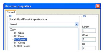
Для совместимости экземплярного блока данных DB\_Zadv и структурного типа Zadv сравните адресов полей, чтобы эти адреса были одинаковыми.
