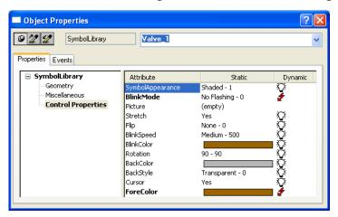
Как видно, свойства, у которых динамика определена с помощью Dynamic Dialog отмечены "молнией" красного цвета. Свойство SymbolAppearance имеет значение Shaded-1, в результате рисунок задвижки отображается плавным фоновым цветом свойства ForeColor.
