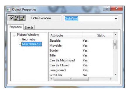
Предположим, что экран процесса Signal.pdl предназначен для отображения характеристик датчика веса и тренда изменения веса. Пусть это окно отображается при щелчке на текстовом поле датчика веса. Для этого откройте окно свойств текстового поля датчика веса и определите следующий обработчик события мыши:
