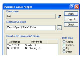
Как видно, здесь имеется 4 варианта определения выражения для динамизации. В этом рисунке выбран вариант **Boolean**, поэтому следует написать булево выражение, при выполнении которого, рисунок задвижки начинает мигать. Определите условие мигания задвижки в виде ИЛИ-условия:
