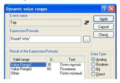
Как видно, в зависимости от диапазона значений датчика веса дозатора в текстовом поле отображается различные тексты.
