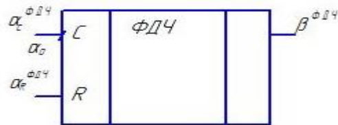
Рис. 11. Условно-графическое изображение ФДЧ
