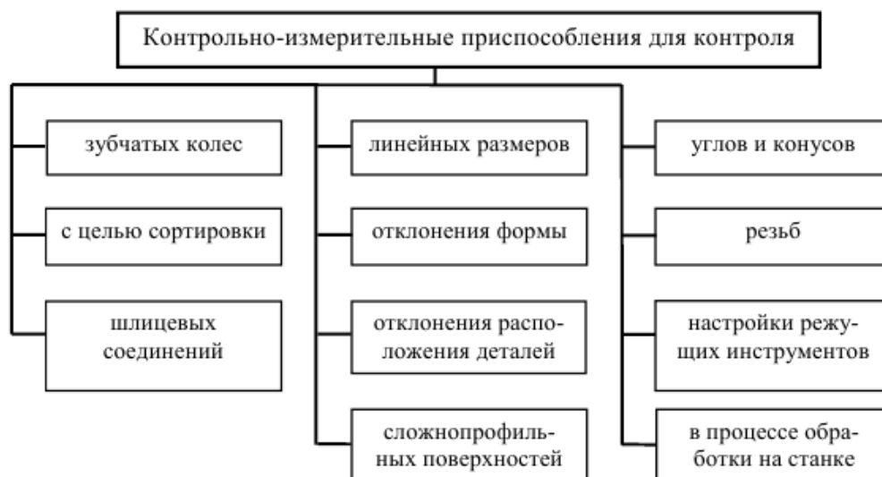
Рис. 5. Классификация КИП по виду контролируемых геометрических параметров
