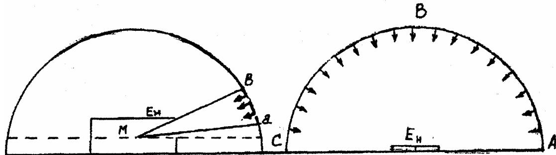
Рис. 8. Определение КЕО
