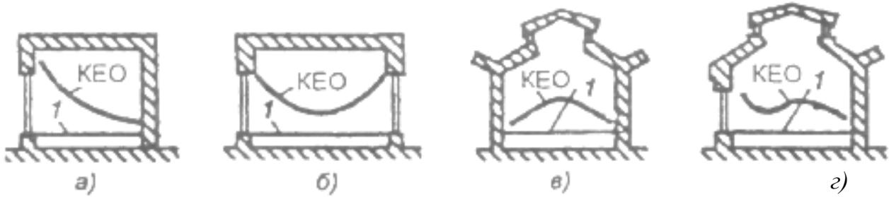
**Рис. 7. Распределение КЕО при различных видах естественного освещения:**
