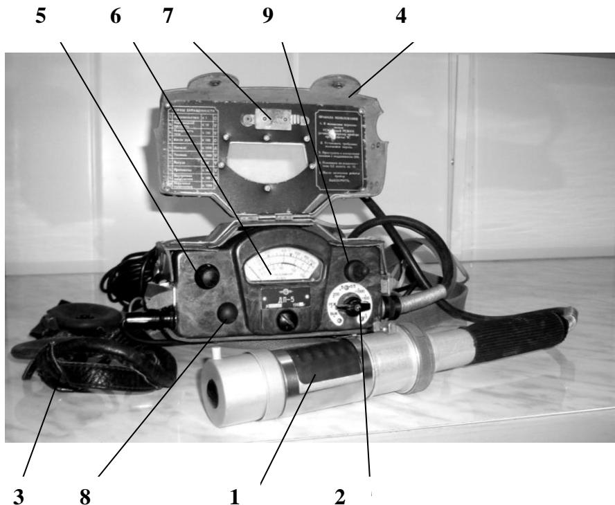
**Рис. 16. Радиометр-дозиметр ДП-5:**
