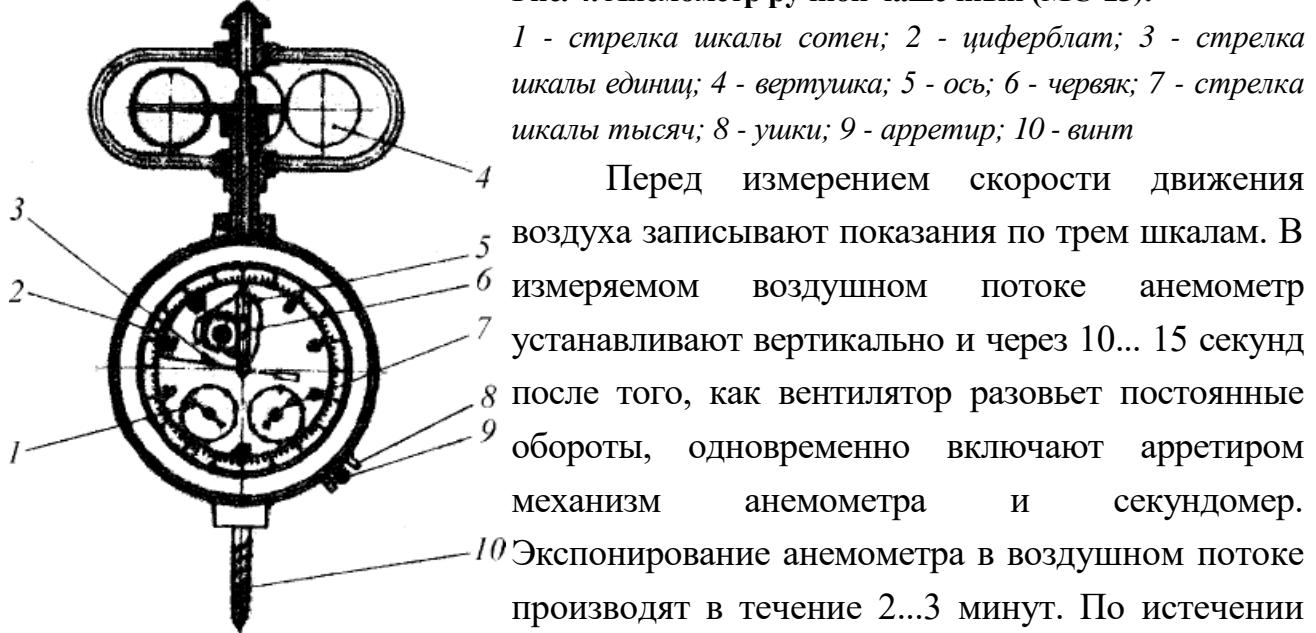
Перед измерением скорости движения воздуха записывают показания по трем шкалам. В измеряемом воздушном потоке анемометр устанавливают вертикально и через 10... 15 секунд после того, как вентилятор разовьет постоянные обороты, одновременно включают арретиром механизм анемометра и секундомер.
