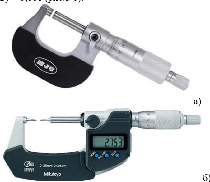
Рисунок 3 – Микрометр: а) с отсчетом показаний по нониусу; б) с отсчетом электронному цифровому устройству
