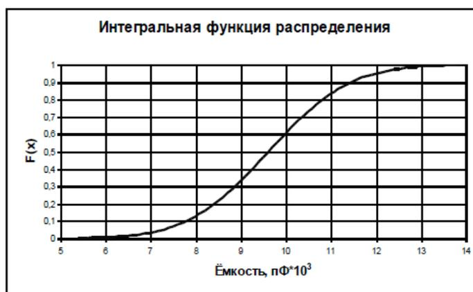
Рис. 1.2. Интегральная функция распределения ёмкости пластин пьезоэлементов
