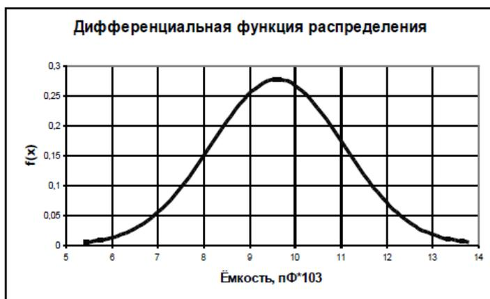
Рис. 1.3. Дифференциальная функция распределения ёмкости пластин пьезоэлементов
