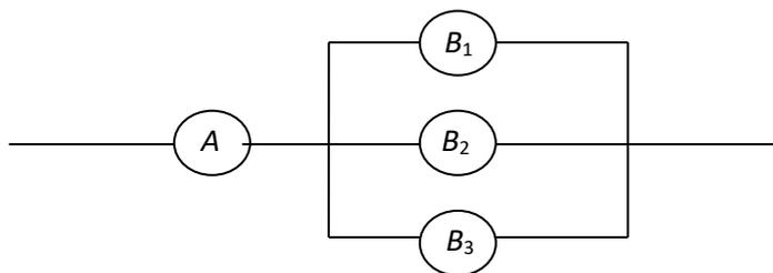
Событие  $A$  – работа элемента  $A$ ;  $B_i$  – работа элемента  $B_i$  ( $i = \overline{1,3}$ );  $C$  – работа цепи. Найти правильное выражение для  $C$ .
