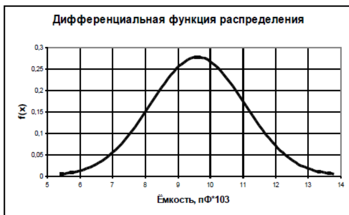
Рис. 1.3. Дифференциальная функция распределения ёмкости пластин пьезоэлементов
