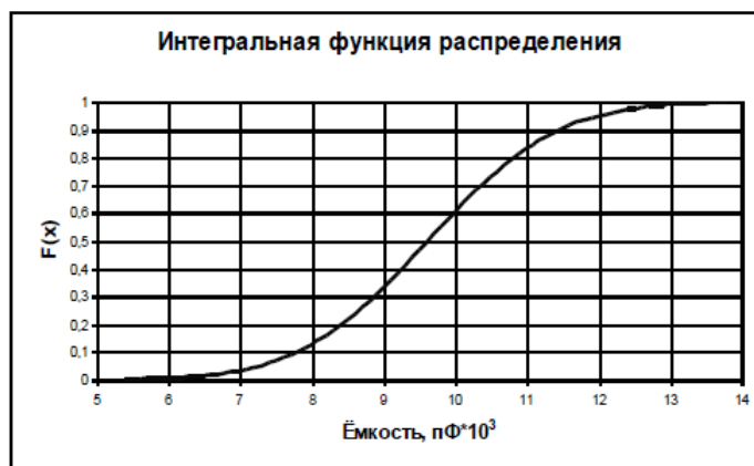
Рис. 1.2. Интегральная функция распределения ёмкости пластин пьезоэлементов
