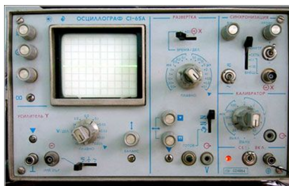
Рис. 4.3. Внешний вид осциллографа С1 – 65А
