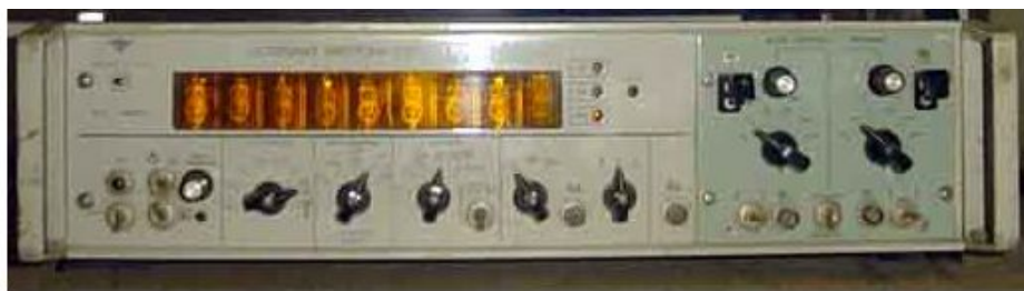
Рис. 4.4. Внешний вид частотомера ЧЗ – 34
