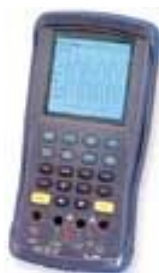
Рис. 2.1. Цифровой осциллограф MS – 2000
